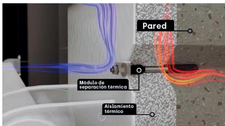
En conclusión, para asegurar la instalación de cualquier carga sobre SATE, es fundamental emplear soluciones especializadas. En concreto, para instalar altas cargas, es esencial que cuenten con homologación ETA. Esta medida no solo garantiza la estabilidad y seguridad requeridas, sino también garantiza la continuidad de la eficiencia energética del edificio.
