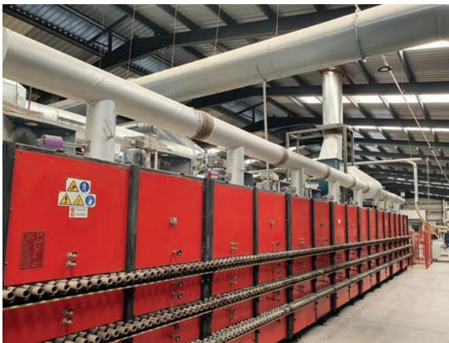
Los analizadores **Bluesky® RH** se sitúan en las aspiraciones de cada uno de los módulos de recirculación, así como en las chimeneas de tal modo que permiten tener un control en continuo de la humedad presente en los gases que fluyen a través del secadero y obtener una combustión más eficiente en los grupos de quemadores.
