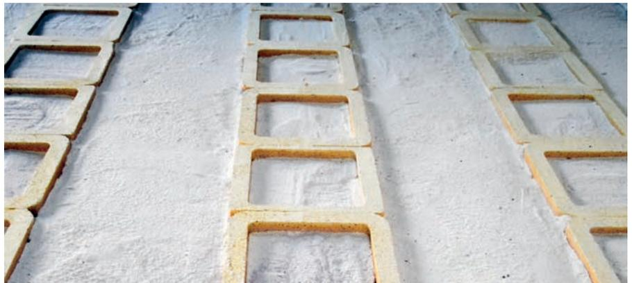
garantizan un funcionamiento sin estorbos en el marco de los procesos de cocción en la industria de tejas.
